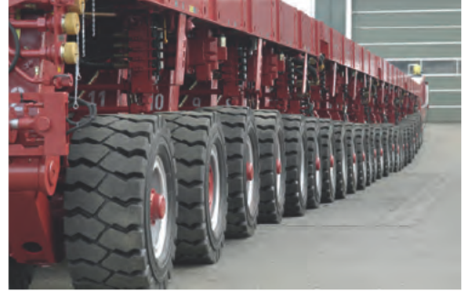
Şekil 2: Artuklu Hamamı'nın taşınmasında kullanılan araçların tekerlekleri
